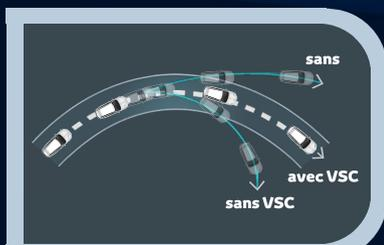
**VSC - Contrôle de stabilité des véhicules**
