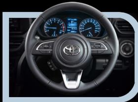
**Volant en cuir** avec commandes pour gérer le Bluetooth, l'audio et le régulateur de vitesse.
